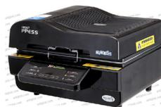
Mediante una combinación de **presión de vacío** y calor para envolver el papel transfer al producto en blanco a personalizar, los nuevos **hornos 3D** son capaces de transferir mediante sublimación 3D todo tipo de superficies de forma curvada y en tres dimensiones, carcasas de móviles, vasos, tazas, alfombrillas de ratón, platos, pizarras, carcasas de tablet, azulejos, etc. Para ello incluye moldes, abrazaderas y membranas de recambio.
