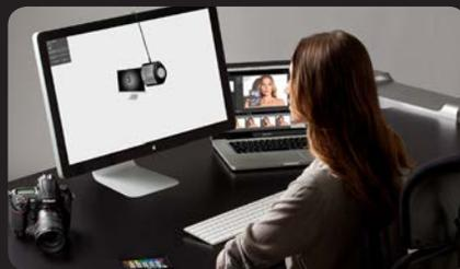
**Perfilado de pantallas** – gire el brazo del difusor de la luz ambiental y ajuste el contrapeso integrado a lo largo del cable USB pulsando un botón para facilitar el perfilado de la pantalla.
