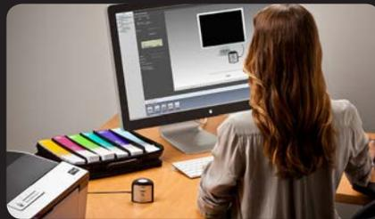
**Medición de la luz ambiental** – un difusor integrado le permite realizar mediciones de la luz ambiental en su entorno de trabajo.
