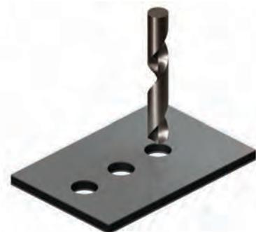
ALUPANEL se perfora fácilmente - para mejores resultados, utilice brocas de perforación diseñadas específicamente para perforar aluminio y plástico. Para agujeros grandes, se requiere una broca de perforación con un punto de localización.
