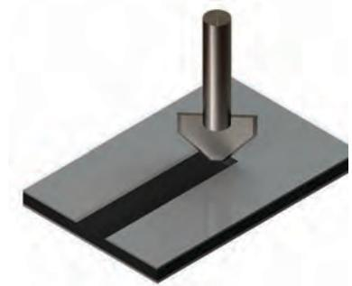
Incluso ALUPANEL se puede doblar fácilmente a mano si se fresa una ranura en forma de "V" en la parte posterior del panel. Esto se puede hacer utilizando una fresado convencional (disponible en su tienda DIY local) o una máquina fresadora CNC. Se debe dejar un mínimo de 0,30 mm de polietileno en la capa posterior cuando se fresa para evitar esquinas puntiagudas o un raspado de la pintura.
