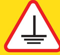
Conecte la máquina a un enchufe conectado a toma a tierra.
