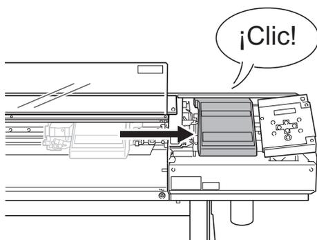
5. Aplique presión con suavidad desde el extremo derecho para comprobar que los cabezales no se mueven hacia la izquierda.
