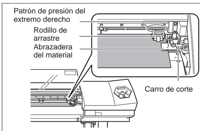
**Coloque los rodillos de arrastre encima de los rodillos de presión.**
