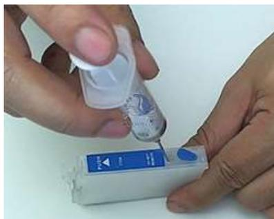
**Recargar el cartucho hasta un 90% aprox.** El indicador del nivel de tinta de la impresora no da una lectura correcta, por lo que se recomienda estar atento y **no dejar en ningún momento que el cartucho se vacíe por debajo de un 10%**, para evitar la entrada de aire por la boquilla. Si esto pasara, realizar limpiezas hasta que vuelva a fluir la tinta nuevamente.
