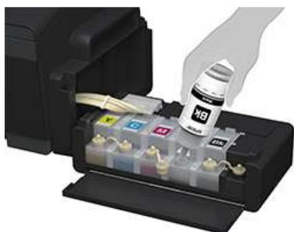
En el caso de las impresoras de tipo EcoTank, hay que **llenar los tanques antes de encender la impresora** (no es necesario rellenar cartuchos) y recomendamos mantenerlos con un **mínimo de tinta de un 20%**, aproximadamente, para evitar la entrada de aire al cabezal de impresión. Si la impresora usa dos tanques de color negro, rellenar ambos de ese color.
