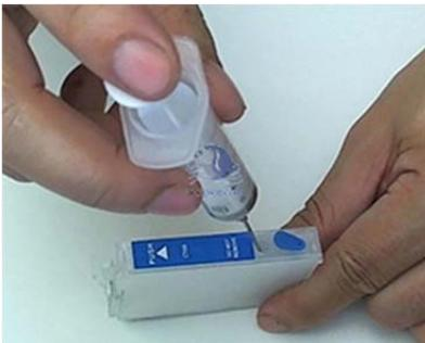
Tras realizar la recarga es recomendable hacer una purga: introducir la jeringa con mucho cuidado en el orificio inferior (la boquilla de impresión, orificio 3 de la imagen) y extraer un poco de tinta, volviendo a introducirla por el orificio de recarga normal.
