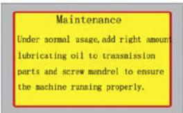
Para un correcto funcionamiento, lubrique regularmente con aceite mineral en la cantidad correcta las piezas de la transmisión y el tornillo sin-fin de avance, y apriete el tope trasero para asegurar que la máquina funcione correctamente.
