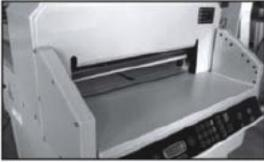
No corte material duro o material que pueda astillarse. Y **no fuerce el motor** de corte, adapte el grosor de corte a los materiales a cortar, no es igual cortar 6cm de papel que 4cm de papel sintético, cartón, polietileno o polipropileno, el motor sufre mucho más.
