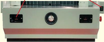
**IMPORTANTE:** Si su cuchilla se atasca en medio de un corte o está en posición bajada por cualquier motivo, no presione ambos botones de corte. Hacerlo puede quemar el fusible de la guillotina. El procedimiento adecuado es invertir la dirección hasta subir la cuchilla mediante la pulsación simultánea del botón de corte mano izquierda y el interruptor del botón de subida. Nunca intente el proceso de corte a menos que la hoja esté en la posición superior.
