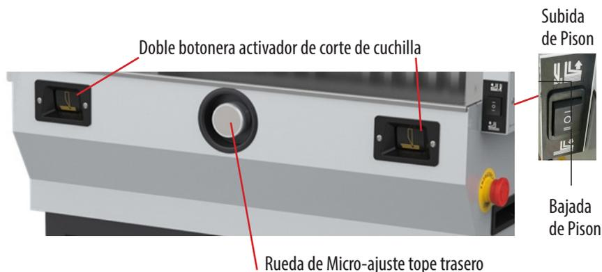
Una vez que haya subido la cuchilla, debe determinar por qué se atascó. La razón más común es que estás cortando demasiado papel. No intente cortar dos pilas de papel una al lado de la otra.
