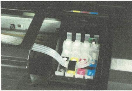
Instale la pinza con forma de "T" con la cinta adhesiva que incorpora retirando el protector.
