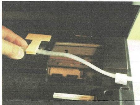
Compruebe nuevamente que el carro de los cartuchos se puede desplazar libremente sin obstruir la manguera ni que quede tirante. Tanto la pieza en forma e T como la pinza simple se han de situar donde mejor sujeten la manguera y que permita el cierre de la tapa.
