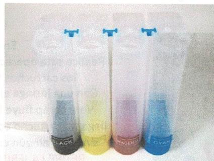
Con el tapón pequeño instalado y a través del agujero grande, rellene cada depósito con la tinta del color correspondiente. Recárguelos hasta un máximo del 80% de su capacidad, dejando un espacio sin rellenar en la parte superior de unos 3 cm. Vuelva a tapar nuevamente los orificios de llenado y presurización para poder realizar el volcado de los tanques y presurizarlos.
