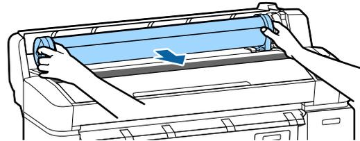
**7** Levante las palancas de bloqueo de los adaptadores para soltar los adaptadores del rolo de papel.
