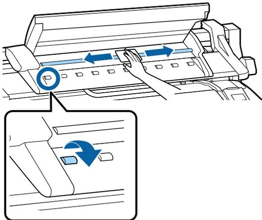
**5** Cierre la cubierta del escáner hasta que oiga un clic.
