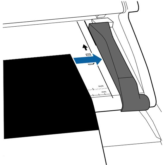
**3** Introduzca la hoja de calibración horizontalmente hasta que el borde toque el rodillo interior.
