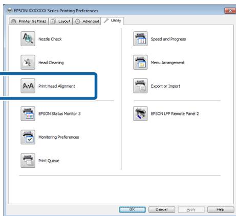
El sensor lee el patrón de ajuste durante la impresión, y registra el valor de ajuste óptimo en la impresora.
