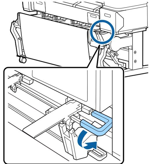
Tal como se muestra en las siguientes ilustraciones, ajuste la guía de apilado inferior para que coincida con el tamaño del papel que debe recogerse.
