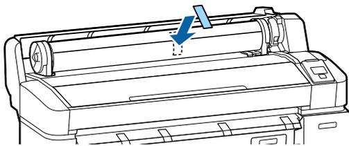
**5** Levante la palanca de bloqueo del rolo.
