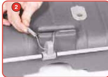
Colocar la fijación inferior en su lugar metiendo las sujeciones en el canal de la base.
