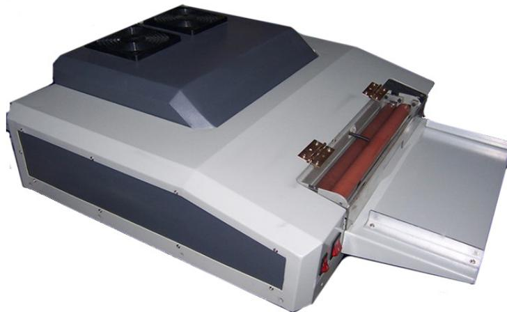
Barnizadora especial para impresiones en digital y offset así como photo albums, tiene la particularidad de realizar el proceso con una solución líquida especial que da un realce y acabado al original impecable y duradero.
