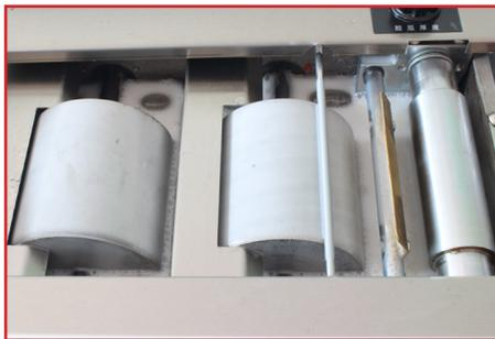
Para el funcionamiento perfecto de la máquina es importante disponer de la cantidad adecuada de adhesivo en la cubeta o tanque de cola (colero). Los indicadores de nivel que se pueden encontrar en el bote permiten verificar su cantidad.
