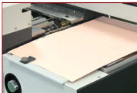
Estación de sujeción de cubierta ajustable para diferentes tipos de cubierta
