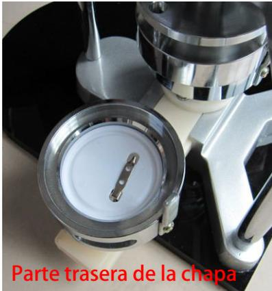
**B.** Coloque la parte trasera de la chapa en el molde derecho
