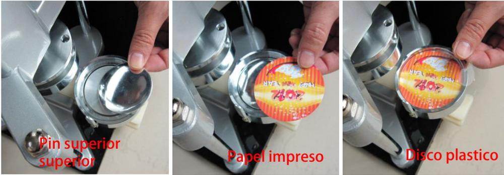
**A.** Coloque la parte de chapa por la cara de exposición, el círculo de papel impreso y el disco de plástico protector en ese orden y sitúelo en el molde izquierdo
