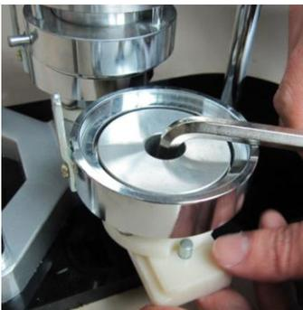
1. Cuando coloque los moldes inferior de izquierda a derecha, el molde izquierdo y el superior no estarán alineados, utilice la llave hexagonal para aflojar el molde, y luego desplace manualmente el molde hasta que esté alineado con el superior, haga lo mismo con el molde derecho.
