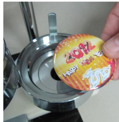
**E.** Levante la palanca, coloque los moldes inferiores hacia la izquierda. La chapa estará lista
