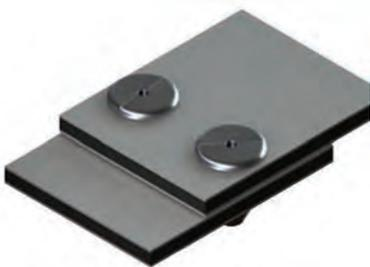
La ALUPANELXTSERIES puede remacharse con equipo estándar utilizando remaches o remaches ciegos. Para el uso externo, remítase a nuestro documento sobre expansión térmica (pídalo a su distribuidor/gerente de ventas local).
