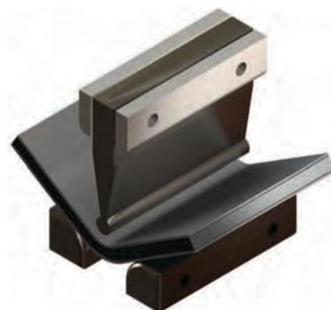
Utilice una mesa de doblado. Radio mínimo interno  $r = 40xt$  ( $t =$  grosor del panel)
