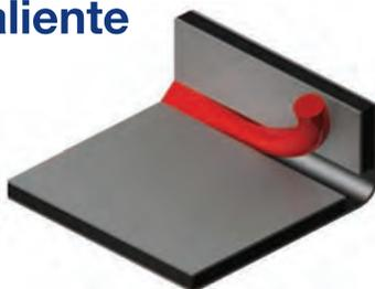
Disponemos de una varilla de polietileno para soldadura que se usa con un equipo elÁctrico de soldadura de aire caliente.
