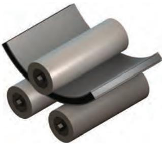
Para curvar con un diámetro interno amplio se recomienda utilizar una curvadora de paneles de 3 rodillos.
