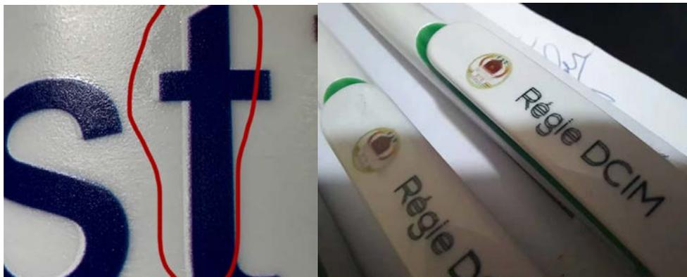
Change the software setting as picture red mark - Cambiar la configuración del software cuando la tinta blanca se vea desplazada sobre la tinta CMYK.
