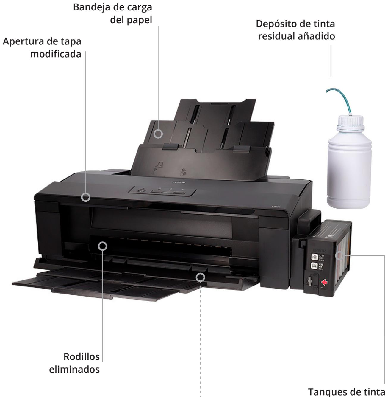
El papel debe salir completamente horizontal por lo que se sustituye la bandeja de salida o se incluye una carpeta para garantizarlo.
