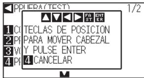
7 Presione la tecla de posición (▲▼◀▶) para mover el carro de la herramienta a la posición de inicio de la impresión.
