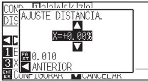
7 Presione la tecla POSITION (▲▼) e incremente o disminuya el valor del parámetro.
