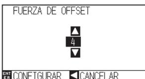
4 Presione la tecla POSITION (▲▼) e incremente o disminuya el valor del parámetro.
