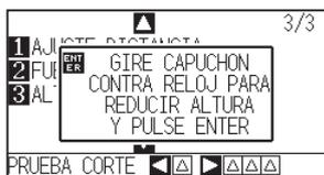
6 Siguiendo las instrucciones, gire a la izquierda la rueda de ajuste de la longitud para retraer completamente la cuchilla.
