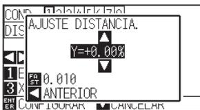
10 Presione la tecla POSITION (▲▼) e incremente o disminuya el valor del parámetro AJUSTE DISTANCIA Y.
