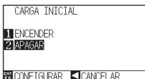
4 Configure el modo presionando la tecla [1] (ENCENDER) o la tecla [2] (APAGAR).
