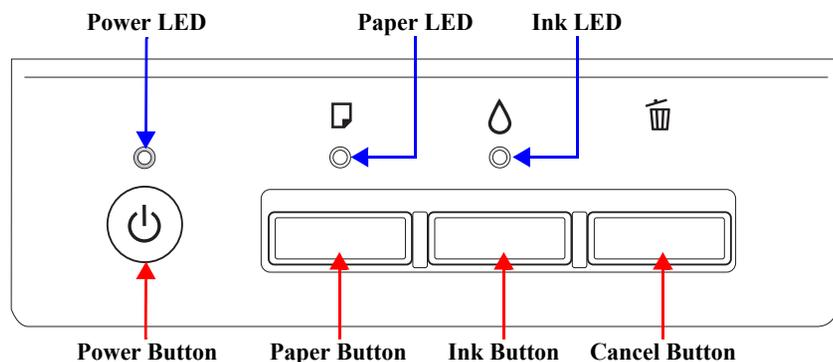
**Figure 1-1. Buttons & LEDs**
