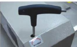
Pruebe con una sola hoja de papel de 80 g/m<sup>2</sup>. Si el papel no puede cortarse por completo, ajuste la profundidad de la cuchilla (rango de profundidad ajustable unos 5mm aproximadamente).
