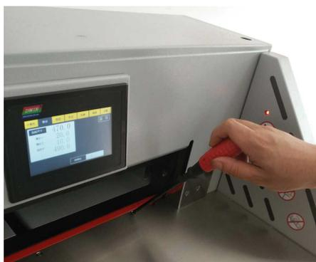
**Nota: Cuando se cambia el cuadradillo, también se debe ajustar la cuchilla. Si la cuchilla corta demasiado, la cuchilla se dañará fácilmente y se desgastará rápidamente.**
