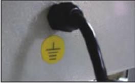
Debe utilizar el enchufe con el cable de tierra conectado
