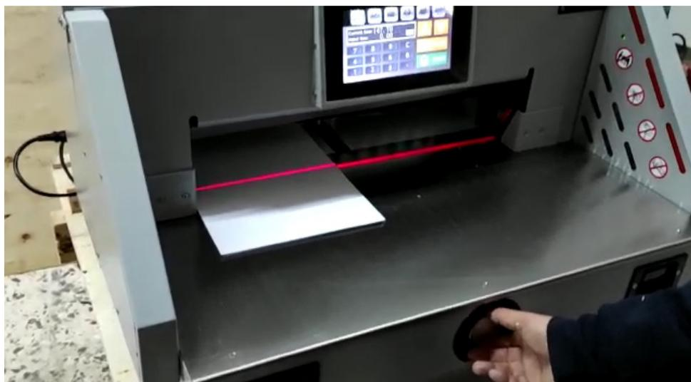
**La guillotina dispone de 3 modos de avance del tope trasero, encargado de desplazar el papel. El modo Manual, Automático y el calculado**
