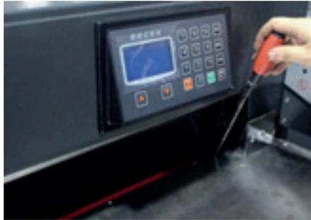
**Nota: Cuando se cambia el cuadradillo, también se debe ajustar la cuchilla. Si la cuchilla corta demasiado, la cuchilla se dañará fácilmente y se desgastará rápidamente.**
