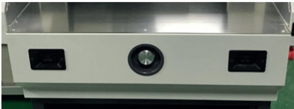
Sólo necesita pulsar la doble botonera de corte simultáneamente para que la guillotina corte de modo automático los diferentes tamaños de corte configurados en el programa (pasos). Cada programa puede tener hasta 99 pasos configurados.
