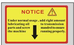
En condiciones normales de uso, lubrique regularmente con aceite lubricante mineral en la cantidad correcta las piezas de la transmisión y apriete el pistón trasero y el tornillo sinfin de avance para asegurar que la máquina funcione correctamente.
