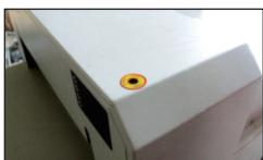
Pruebe con una sola hoja de papel de 80 g/m2. Si el papel no puede cortarse por completo, ajuste la profundidad de la cuchilla (rango de profundidad ajustable unos 5mm aproximadamente).
