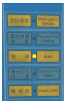
Para finalizar pulsaremos la tecla "START" se pondrá en marcha la bomba de vacío y comenzará la cuenta atrás. Seguidamente se pondrá en marcha el temporizador UV. Cuando termine el tiempo seleccionado terminará el ciclo de exposición.
