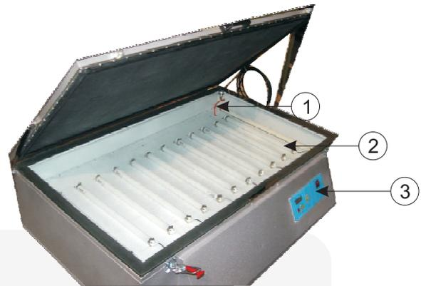
1. Sonda de vacío
