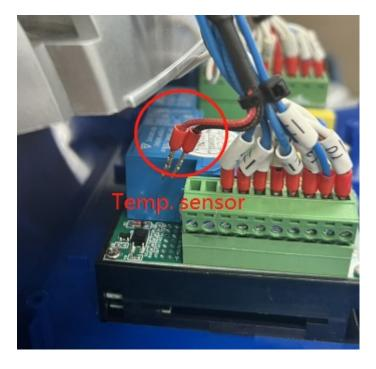
Resetee el circuito, configure la máquina a 30C o menos para la prueba, si el controlador sigue siendo 000, reemplace el controlador
