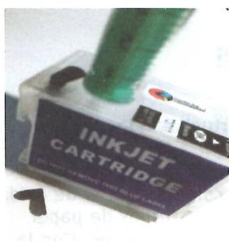
Con el cartucho ligeramente inclinado introduzca la punta de la jeringuilla en el orificio de relleno e introduzca la tinta. Recuerde, el más cercano al chip.
