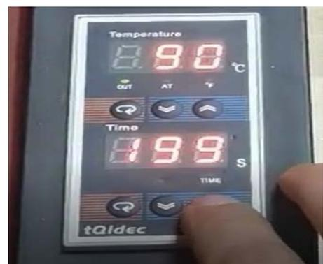
(5) Ajuste la plancha de calor a 160°C y durante 10 segundos precaliente la prenda antes del marcaje, luego configure un marcaje durante 40 segundos para iniciar la transferencia.
