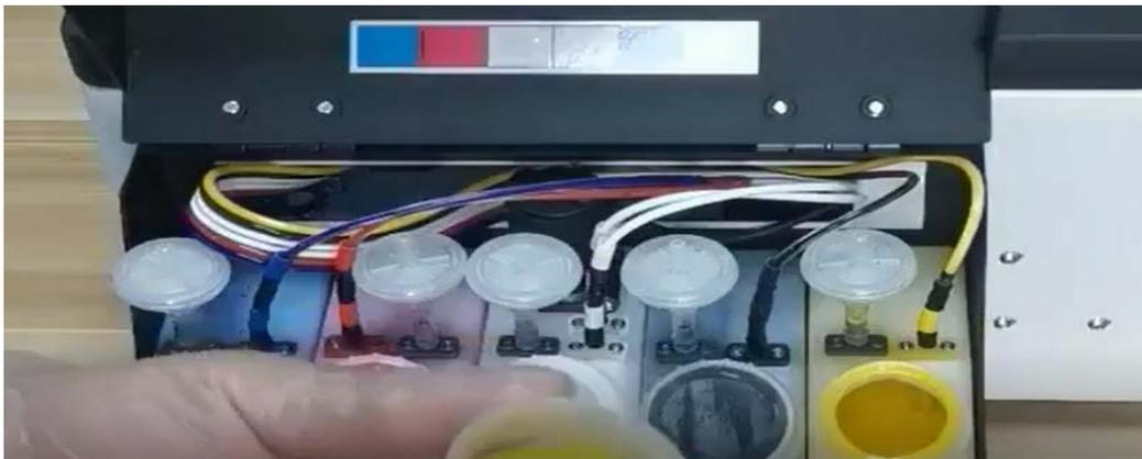
2.2.2. Utilice jeringas con **boquilla de purga**, introduzca la boquilla en el orificio de salida del **dampner** y succione de 2 a 3 ml de tinta de cada uno de los dampers de tinta, respectivamente. Con esta maniobra eliminamos el aire de los conductos facilitando la llegada de tinta al cabezal.
