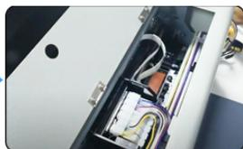
9. Vuelva a colocar los dampers y vuelva a colocar la tapa que los cubre.
