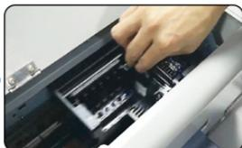
6. Desplace el cabezal hacia la izquierda para dejar al descubierto la estación de limpieza.
