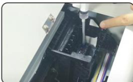
5. Bombee la solución de limpieza sobre la boquilla del cabezal, canal a a canal, sin desbordar el líquido
