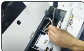
1. Asegúrese del corte de energía de la impresora. Utilice un destornillador para desatornillar la impresora.
