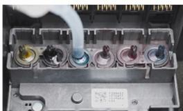
**Precaución:** los desbordes de líquido limpiador sobre cable de datos, placa y demás componentes electrónicos pueden provocar un cortocircuito, asegúrese de secar todo antes de volver a conectar.
