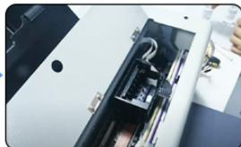
3. Retire todos los dampers de tinta, luego mueva el cabezal hasta la posición de descanso sobre la estación de limpieza.
