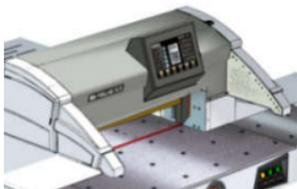
**5. 12 Barreras de seguridad:** Las barreras laterales de la mesa de trabajo contienen unos sensores infrarojos que detienen la maquina si estan obstruidos. Si hay una obstrucion, sonara una alarma y ni la cuchilla ni el pison funcionarán.
