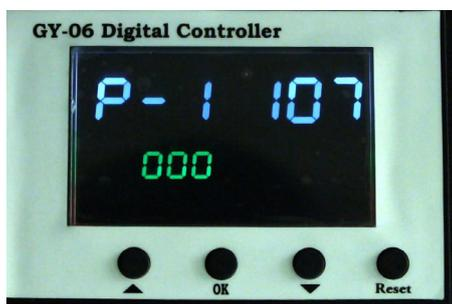
Cuando existen diferencias entre la temperatura establecida SV (la temperatura de transferencia mostrada en pantalla) y la temperatura real de la placa de calor (medida con un termómetro de precisión) , mantenga pulsado el botón **OK** durante 5 segundos para acceder al modo de calibración de temperatura **P-1**.
