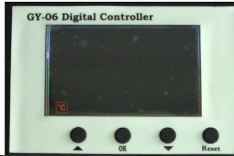
Presione el botón **OK** . La luz
