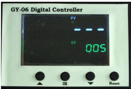
Presione el botón **OK** después de configurar la temperatura de transferencia (SV). El piloto de tiempo se encenderá. Pulse las flechas "Δ" o "▽" para configurar el tiempo de planchado según las instrucciones del producto a marcar.
