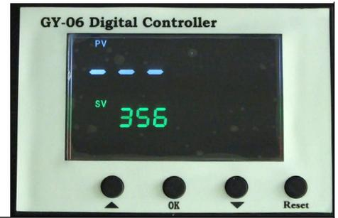
Presione el botón **OK** . El piloto de temperatura se encenderá. Pulse las flechas "Δ" o "▽" para configurar la temperatura según el producto. (180°-200°C). SV: Temperatura deseada (configurada) PV: Temperatura actual
