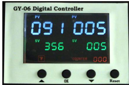
Presione el botón **OK** para ir al modo de funcionamiento. El contador (counter) marca el "ciclo de transferencia", va desde 0 ~ 999. Pulse "Reset" durante 5 segundos para volver a poner el contador a "0".
