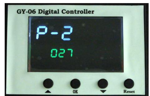
Cuando SV y PV presenten una gran diferencia de temperatura con la realidad. mantenga pulsado el botón **OK** durante 5 segundos y vuelva a pulsarlo de nuevo para ajustar la temperatura **P-2**. Si SV y PV tienen una diferencia de 20°C con las flechas "Δ" o "▽" configuramos 20 °C.
