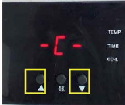
Pulsa el botón OK, el visualizador indica C que se refiere a grados centígrados. Pulsa las flechas ^ o v para seleccionar "C" para medir la temperatura en grados centígrados o "F" para Fahrenheit.
