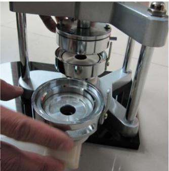
B. Eleve el molde superior y luego coloca los moldes inferiores en el carril deslizante
