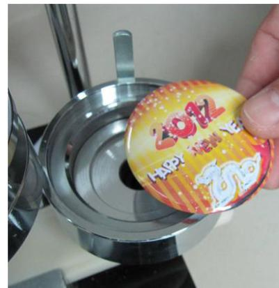
**E.** Levante la palanca, coloque los moldes inferiores hacia la izquierda. La chapa estará lista
