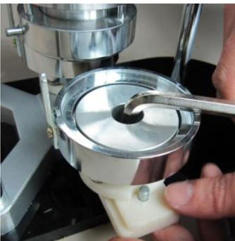
1. Cuando coloque los moldes inferior de izquierda a derecha, el molde izquierdo y el superior no estarán alineados, utilice la llave hexagonal para aflojar el molde, y luego desplace manualmente el molde hasta que esté alineado con el superior, haga lo mismo con el molde derecho.
