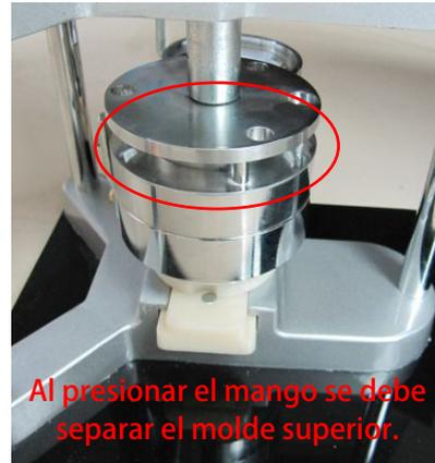
**C.** Sostenga con firmeza la máquina mientras presiona el mango, la máquina tiene que estar en una superficie firme, sin desequilibrios al presionar.
