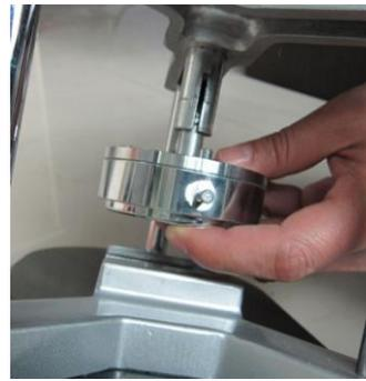
A. Presiona la palanca y mientras tanto, inserte el molde superior en el orificio superior
