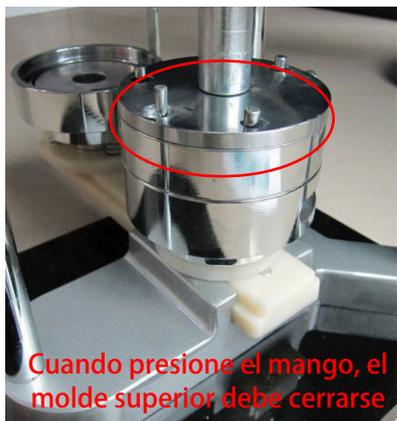
**D.** Levante la palanca, coloque los moldes inferiores hacia la izquierda, podrá ver la cubierta superior de la chapa, el papel impreso, el disco protector se habrán presado en el molde superior y luego presione la palanca nuevamente.
