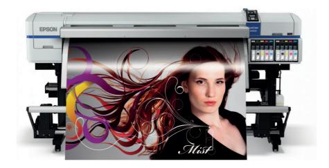
Diseñada para ofrecer un alto nivel de eficiencia, la SC-S50600 utiliza dos cabezales Thin Film Piezo y dos juegos de tinta CMYK (o CMYK + blanco para el modelo de 5 colores) simultáneamente, para imprimir a una velocidad de más de 51 m2/hora. El secador incorporado garantiza que las copias estén listas con rapidez y, para mejorar aún más la productividad, se incluye de serie unidad de secado adicional de Epson.
