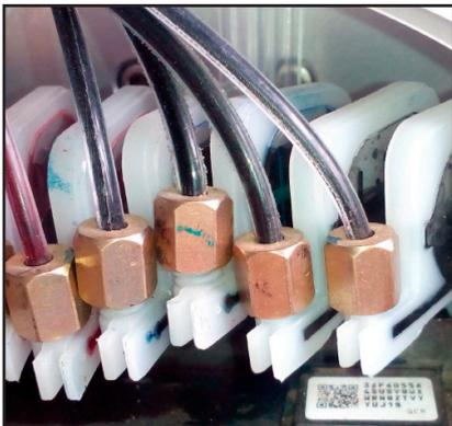
Dampers (filtros) y líneas de tinta de alta duración diseñadas para alimentar al S7000
