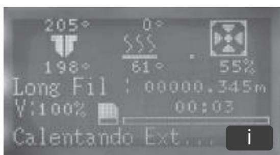
b. Una vez que la temperatura alcanza la temperatura deseada, como abajo en la imagen j, el filamento será semi-descargado del extrusor.
