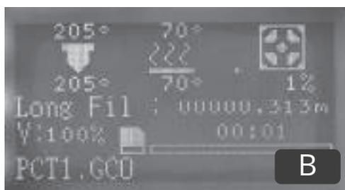
Una vez que la temperatura de la plataforma y la temperatura del extrusor alcanzan la temperatura deseada, la impresora empezará a imprimir.
