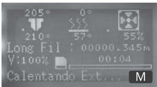
NOTA: la temperatura necesaria para PLA y ABS es diferente. Un ajuste de temperatura incorrecto puede provocar daños en la impresora.
