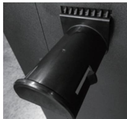
5.8.3 Monte el filamento en el portabobinas y asegúrese de que el filamento puede girar hacia la izquierda libremente.
