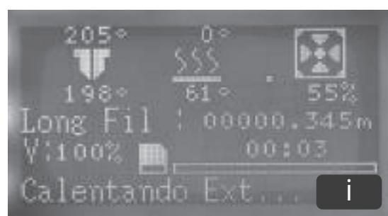
b. Una vez que la temperatura alcanza la temperatura deseada, como abajo en el cuadro j, el filamento será semi-descargado del extrusor.
