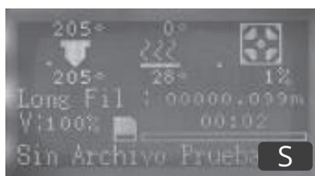
6.4.2 Una vez que la temperatura de la plataforma alcance la temperatura de ajuste como la imagen T, el extrusor se calentará como el cuadro U.
