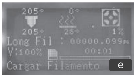
c. Se calienta el extrusor hasta alcanzar la temperatura óptima de extrusión.
