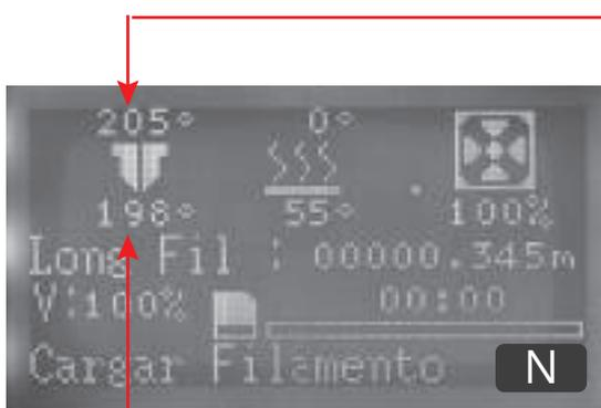
Ajuste de temperatura del extrusor
