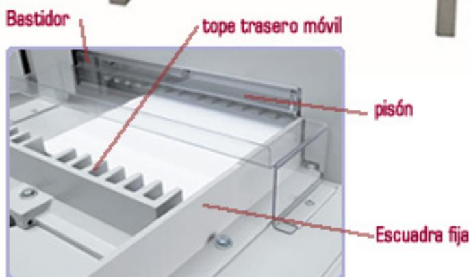
Guillotina manual DC-470 robusta, versátil y de gran fuerza. Dispone de pisón de volante que proporciona una sujeción del papel firme y rápida facilitando el corte recto. Escuadra trasera con regla de marcado guiada milimétricamente por manivela.
