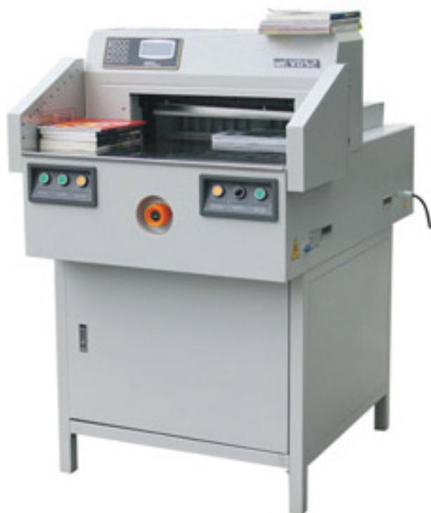
Guillotina programable de 520mm de luz de corte, de gran fuerza y precisión, perfecta para cortar albums fotográficos abiertos. Grosor de corte máximo de 65mm.
